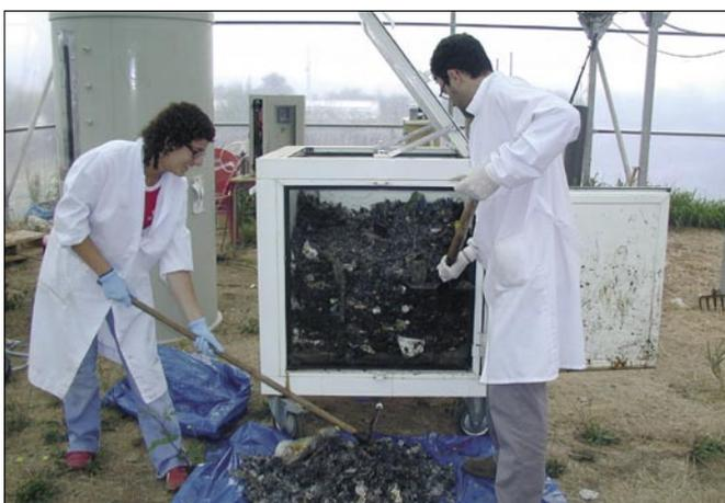
Descarga del residuo del reactor
